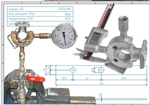
» Druckprobe, Dichtheitsprüfung und Qualitätskontrolle bei allen Armturen
